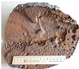
Рисунок 1 - Общий вид повреждения на внутренней поверхности трубы
