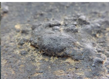
Рисунок 3 - Вид отложений на внутренней поверхности с наростом
