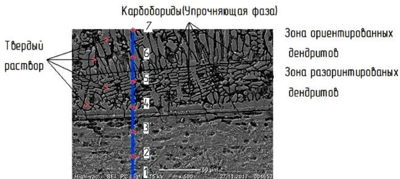
Рисунок 2. Поверхностный слой при лазерной наплавке.
